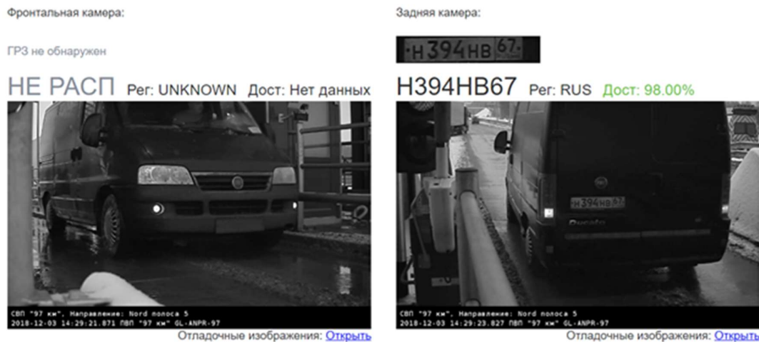
Рис. 3 - Использование задней камеры распознавания ГРЗ для повышения точности идентификации
